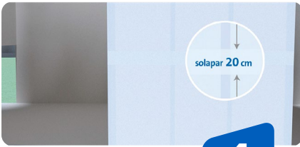
COLOCACIÓN LÁMINA IMPERMEABLE
