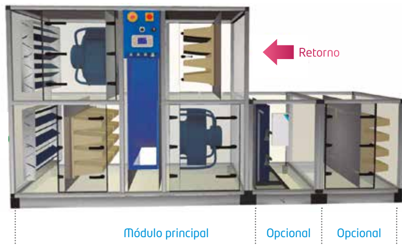
Recuperador rotativo de muy alta Eficiencia
