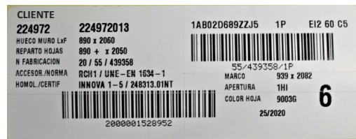
Etiquetado de puertas
